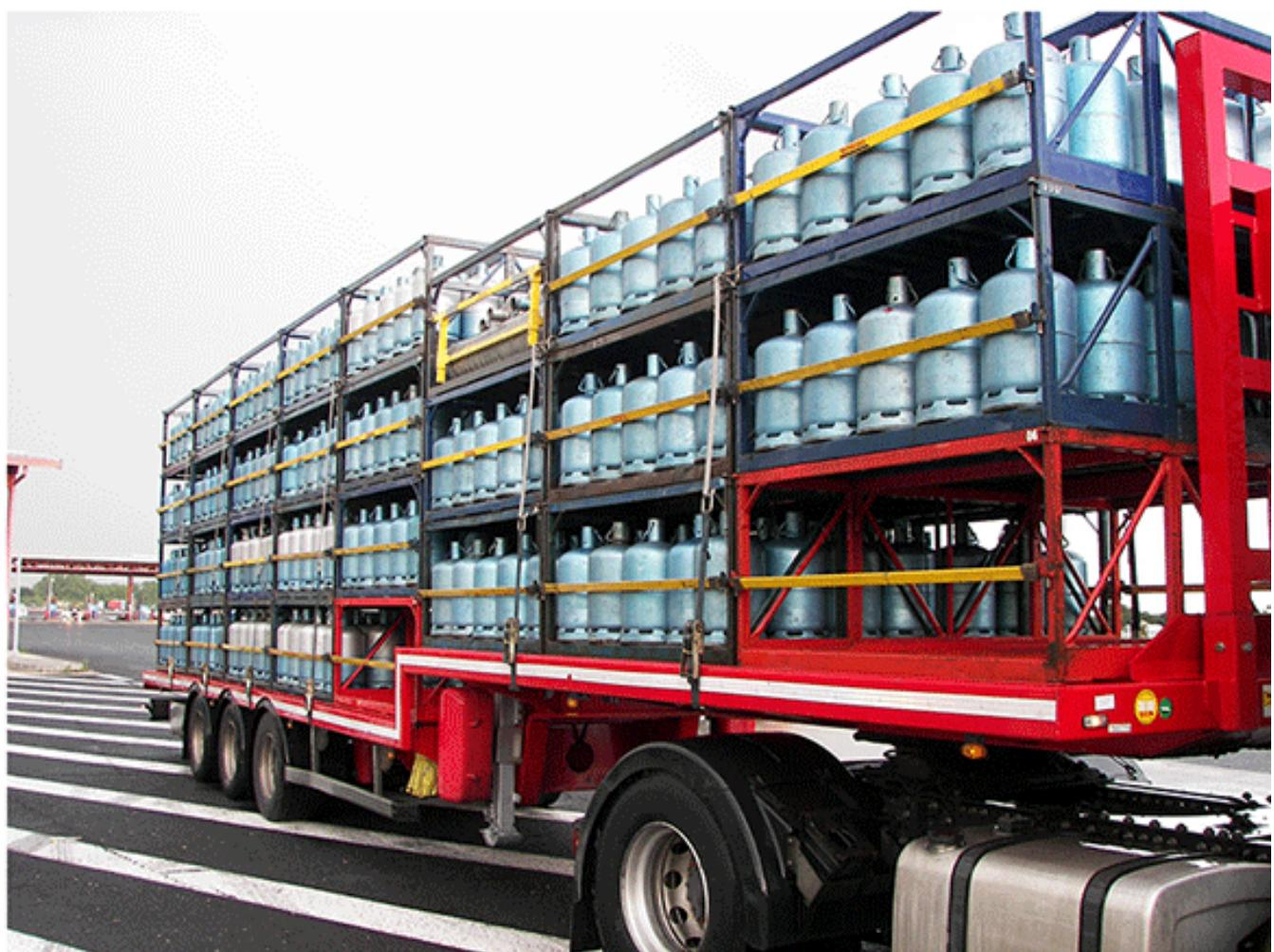
Deben estibarse de forma conveniente no vehículo e suxeitarse entre si por medios adecuados para evitar todo desprazamento das mercadorías. Deben amarrarse mediante abrazadeiras fixadas ás paredes laterais, travesas corredizas e soportes regulables, sacos inchables e dispositivos de peche antideslizante.
